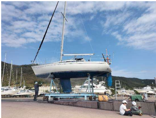
父ちゃんが高圧洗浄して、皆で船底塗料を塗って、夫婦で仕上げる
